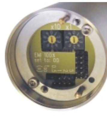
发射率和响应时间可在测温仪上做调节。发射率的旋转开关能够使调校更精确。
