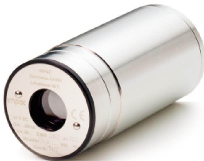
IN 5和IN 5/5是双线制的非接触式远红外测温仪。通过内部的数字式数字化处理, 使得其测量精度比原来的模拟式型号提高大约40%。
