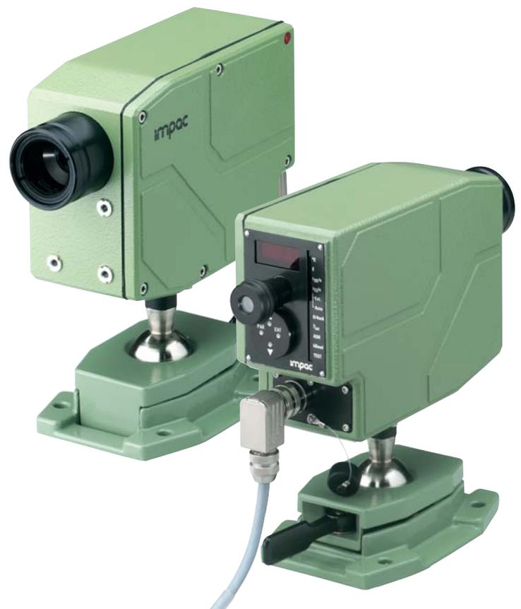
IS12AL 是IS12的补充款，专门为测量铝的温度而设计的远红外非接触式测温仪。它所采用的铝压铸外壳达到IP65的保护等级，专门为工业应用所设计的。用户可以直接在仪器上通过四个按键修改参数。内嵌的数字式显示屏显示相应的系统参数或当前被测的温度。用户也可以通过与数字式接口相连的手持式控制器或通过Infrawin软件对参数进行更改。该软件还可以将测得的温度以图表或数字表格的形式显示和储存。而用来对准测量点的瞄准器使测温
