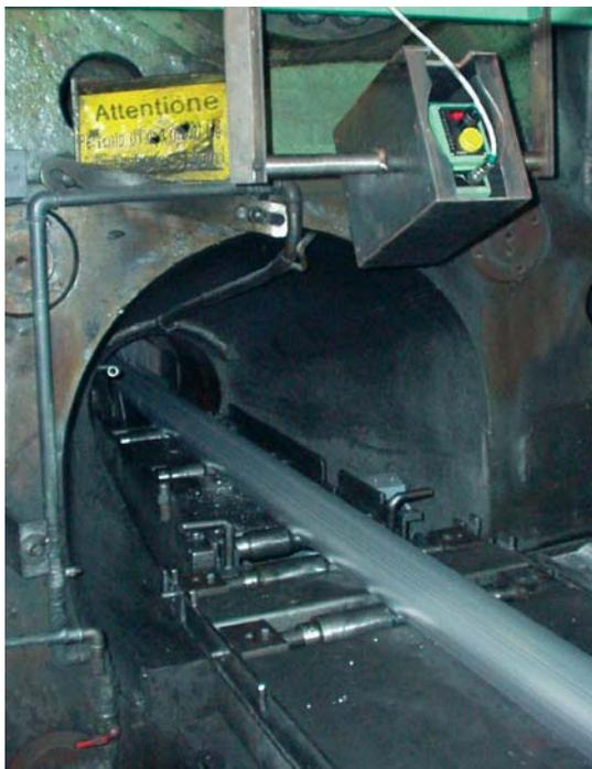
IS12AL 是在IS10基础上进行了改进的红外测温仪, 用于测量铝的温度, 测温范围在350...1050 之间。
