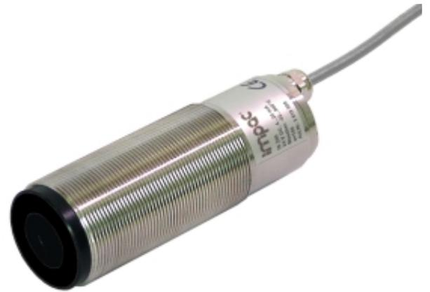
IS200 和IGA200是用于测量金属表面、沥青和陶瓷的固定式远红外非接触式测温仪。
